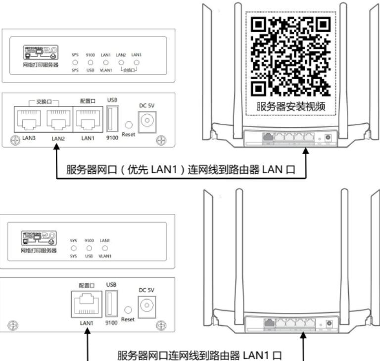
1. 网线连接好后，注意观察服务器对应网口指示灯应该亮起来 !!!
