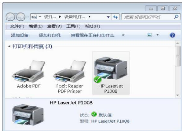
**4.17 选中打印机→右键→打印机属性→打印测试页，看看打印机能否打印出测试纸 整个打印机驱动安装完成。**
